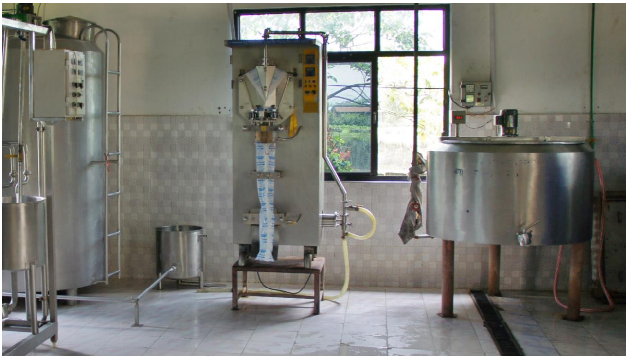
Pastmilch wird in Plastikbeutel abgefüllt (Bildmitte). Im Tank rechts wird Joghurt hergestellt.
